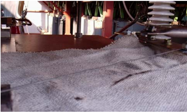
Рис. 2. Общий вид исследуемого оцинкованного стального провода ( l_{\text{п}}=320 мм; r_{\text{п}}=0,8 мм) до воздействия на него мощного аperiodического импульса тока i_{\text{п}}(t)
